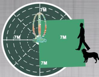
V prípade ak človek alebo zvierat sa priblíži k lampe do 7 m tak snímač zariadenie vypne.
